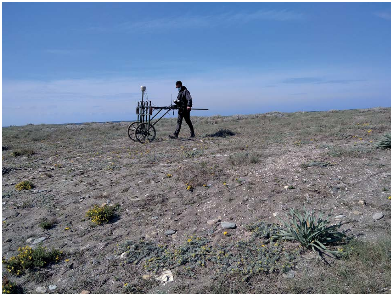
Figura 8.1. Investigador operando el magnetómetro.
