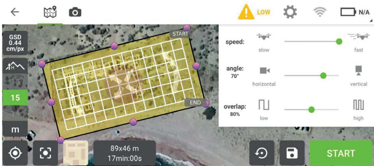
Figura 7.2. Programación del vuelo fotogramétrico desde Pix4Dcapture.
