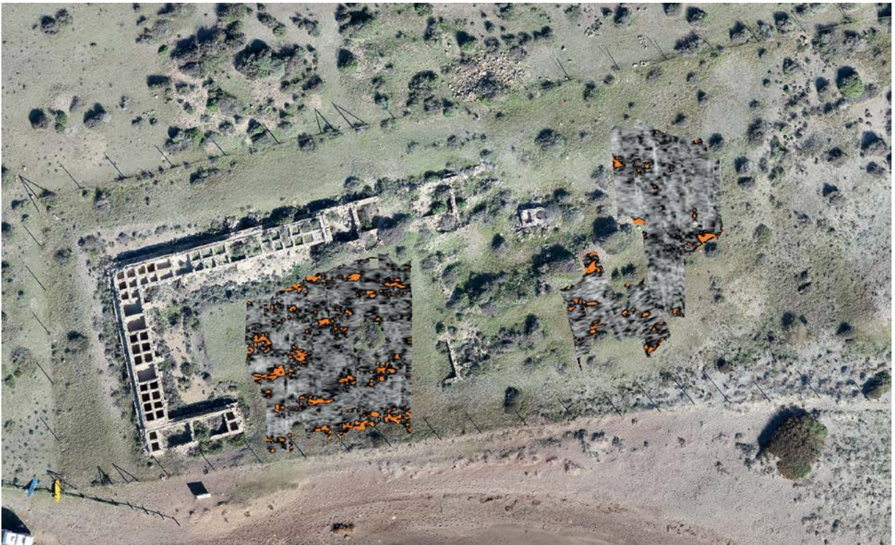
Figura 9.19. Vista general de la exploración georradar a una cota de -1,5 m.
